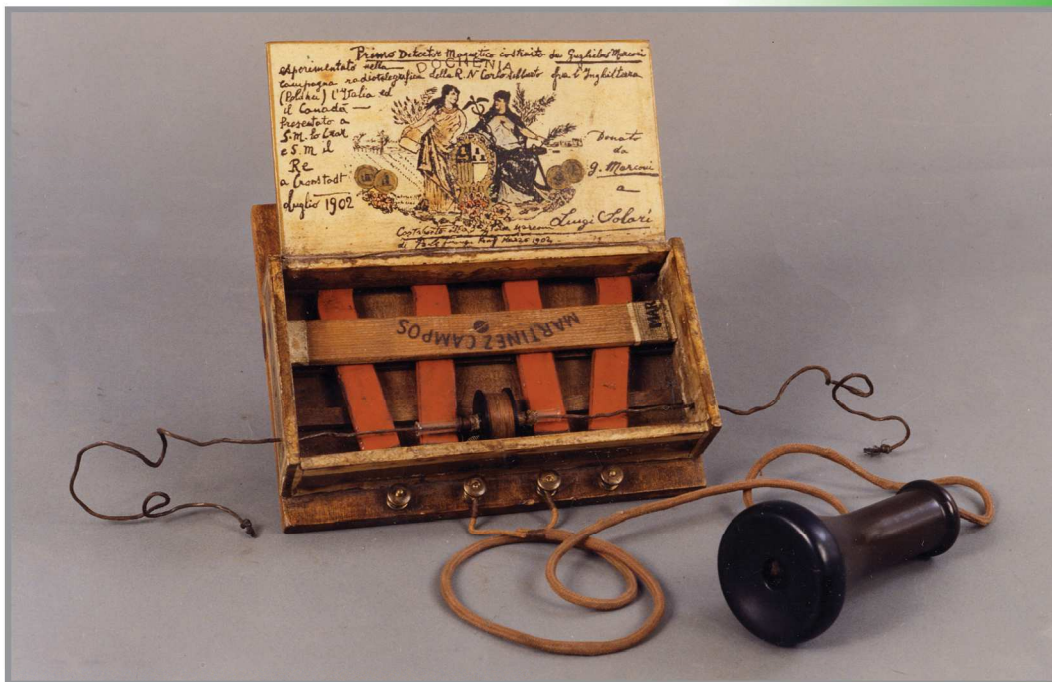
Nuovo ricevitore, il "detector magnetico", brevettato da Marconi nel 1902. E' costituito da due calamite ed un filo metallico che, scorrendo all'interno di una bobina, capta il segnale in arrivo. Il primo prototipo nella foto, venne costruito da Marconi assemblando gli apparecchi in una scatola di sigari.
