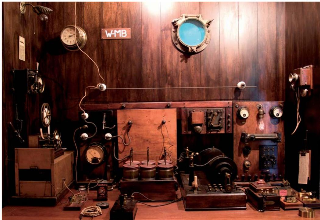
Apparecchiatura trasmittente navale del tipo di quella che era a bordo del *Titanic*.
