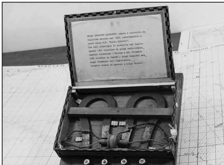
Fig. 3 Detector magnetico del tipo utilizzato sulla "Carlo Alberto" nel 1902
