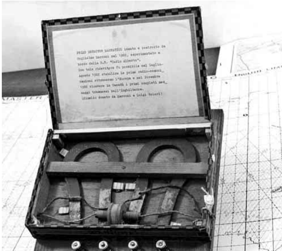
Fig. 57 - Primo detector magnetico costruito personalmente da Marconi assemblando i componenti in una scatola di sigari. Il filo che passa attraverso la bobina viene azionato manualmente.
