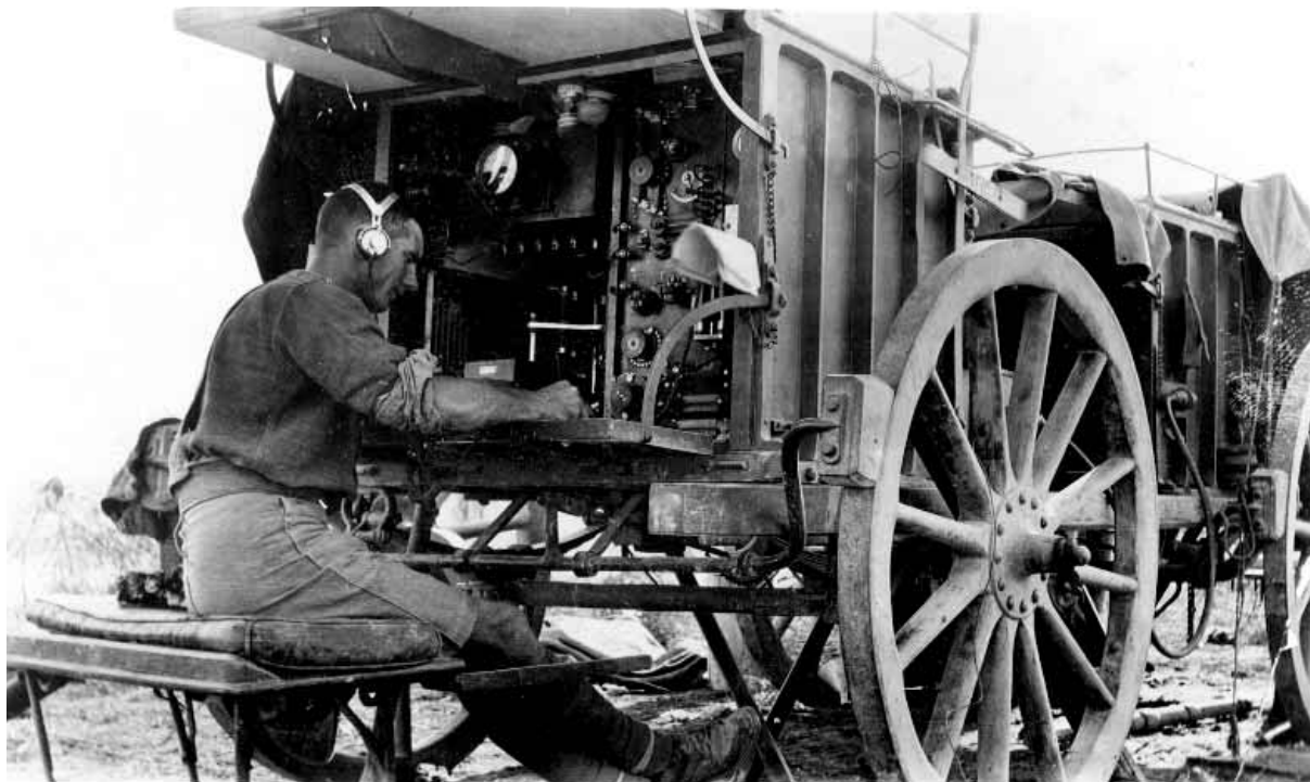
Fig. 103 - Operatore di una stazione radio trasportabile della Marconi installata su un carro durante la prima guerra mondiale.
